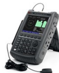
Получение данных геолокации с помощью встроенного приемника ГНСС/GPS
