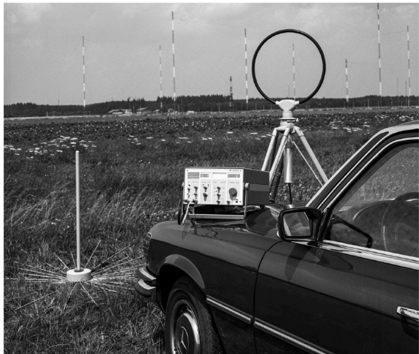
Рис. 9: Поле HFH2 измеритель напряженности с Тестовым приемником ESH 2 и соответствующими антеннами для частотного диапазона от 9 кГц до 30 МГц.
