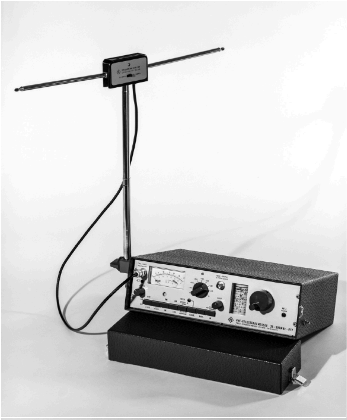
Рис. Г: мобильный УКВ-канал HFV измеритель напряженности поля с дипольной антенной. Эта модель не была единственной полностью твердотельной state Rohde & Schwarz тестируемый приемник, но также первый, способный принимать автоматические помехи взвешивание козырька в соответствии с в соответствии с VDE 0876 или CISPR Оубл. 2.
